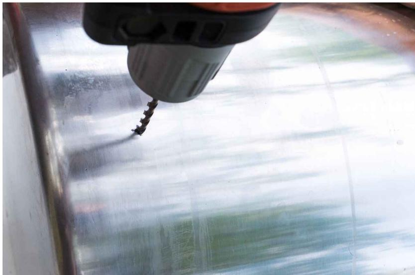
Utiliser un lubrifiant (type WD40 ou autre) lors du perçage. Ça va faciliter le perçage et également diminuer les chances que le forêt ait une durée de vie très réduite !
