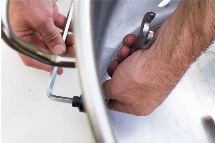
Après quelques tours de la clé allen le poinçon va traverser la paroi de la cuve en faisant une perçage très propre.
