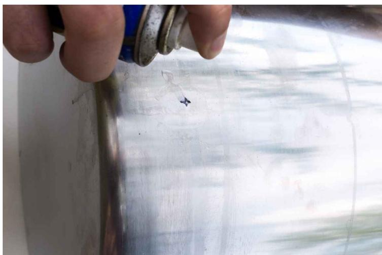
Maintenant utilisez le grand forêt pour le perçage du passage de la vis de l'emporte pièce avec la même procédure qu'avant : un forêt de bonne qualité, une vitesse modérée et un lubrifiant.
