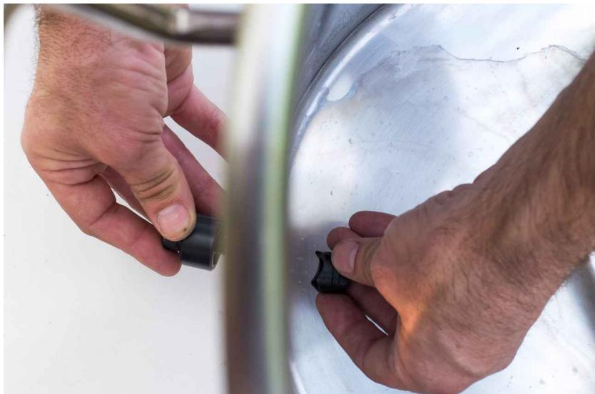
Bloquez le poinçon à l'intérieur de la cuve avec la clé plate et faites tourner la vis CHC avec la clé allen.
