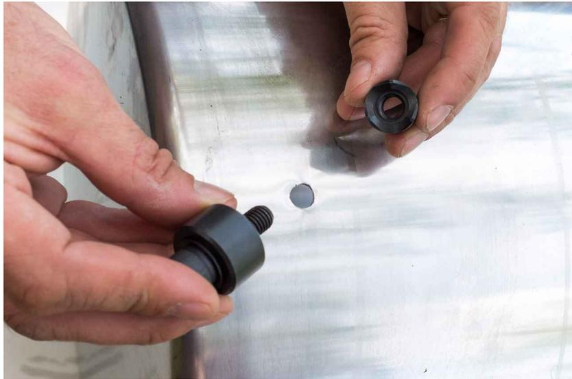
Montez l'emporte pièce à travers la paroi de la cuve avec le poinçon à l'intérieur de la cuve.
